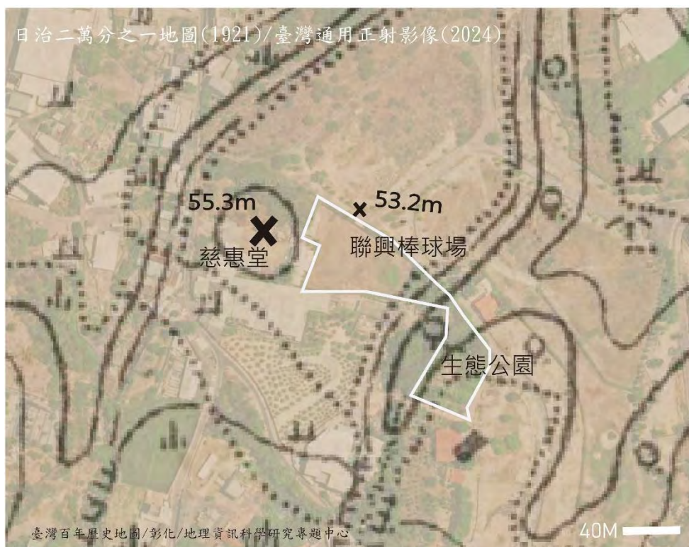
圖5、古地圖上可見聯興棒球場西北側有小土墩，現慈惠堂所在。土墩的邊坡堆積正是棒球場所在。慈惠堂建築基地現已削平了土墩的一半，移除的土方可能也曾往棒球場堆置。
