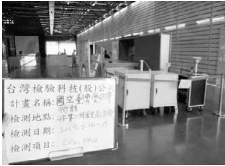
說明：室內空氣品質檢測 (CO 2 、PM 10 ) 日期：2019/03/15 地點：4F 第二特展室前走廊 (#2)
