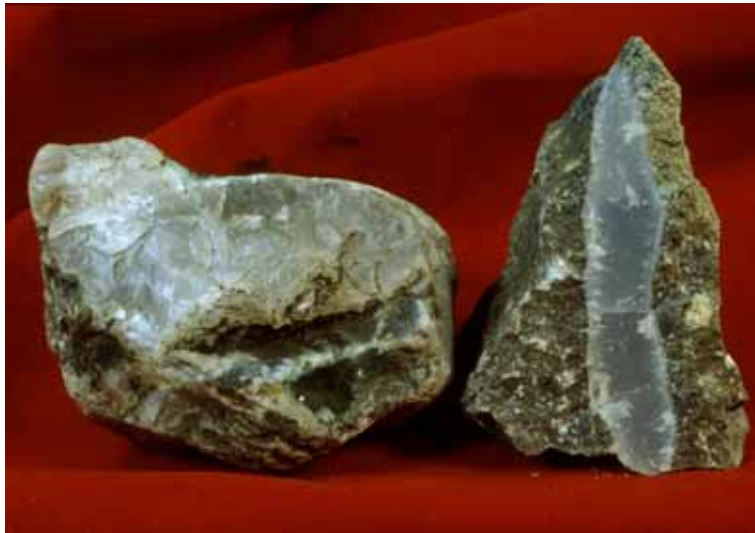
圖五、玉髓沒有結晶外形，有時鑑定不易，用拉曼光譜儀是最好的選擇。
