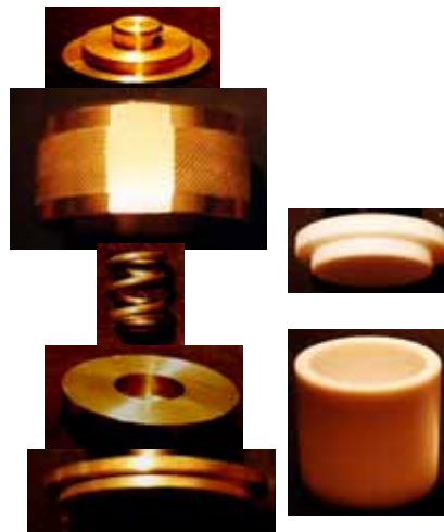
圖一. 自行設計的飽和蒸氣壓反應器
