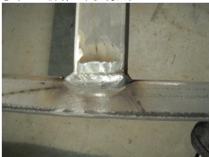
◎焊點及接續點平整度檢查
