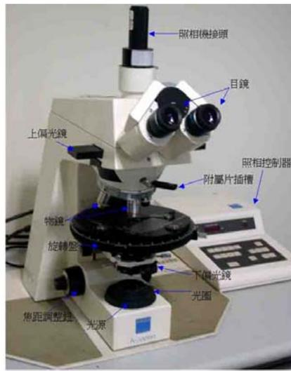
圖 8 偏光顯微鏡
