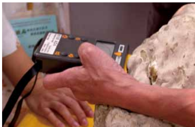
要找北投石時，可利用能偵測放射線的「蓋格計量器」來探尋。
