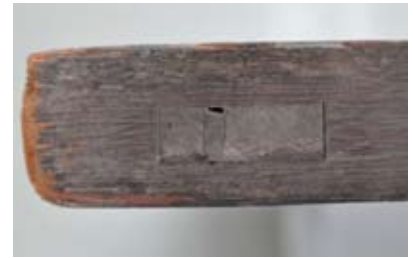
圖23 由頂側及底側觀察，樁頭嵌入木楔片強化接樁強度。
