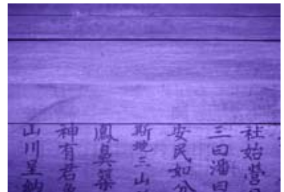
圖38 於紅外線下墨跡清晰可見，但朱字不明顯，鉛筆打稿線條亦可明確分辨。
