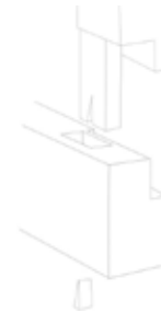
圖21 竹塹社「新社公館」匾之接樁示意圖(帶樁貫穿方樁搭接法)
