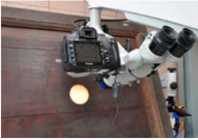
圖65 於實體顯微鏡下觀察清潔過程的塗層狀況。
