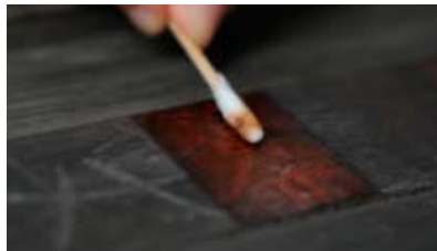
圖6 以三乙醇胺緩衝水溶液進行塗層移除測試 攝影日期:2011/03
