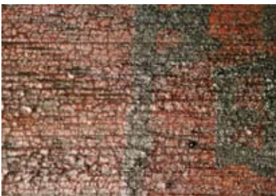
圖68 清潔中，實體顯微鏡下觀察以純水清潔白色粉筆字跡與髒污。
