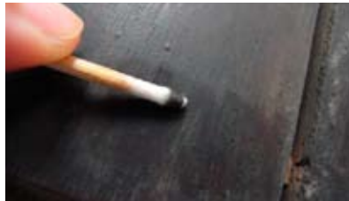
圖5 以純水進行濕式清潔測試 攝影日期:2011/03
