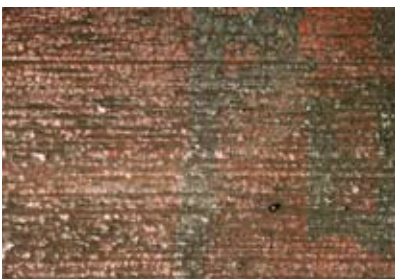
圖69 清潔後，實體顯微鏡下，白色粉筆字跡與髒污已移除，僅細裂紋孔隙留存部分髒污。
