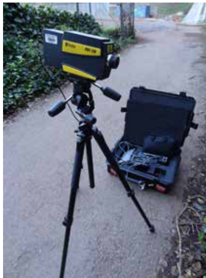
圖7 攜帶式雷射都普勒測震儀，讓生物學家能在野外實地量測並記錄震動訊號與噪音。(吳忠慧攝影)
