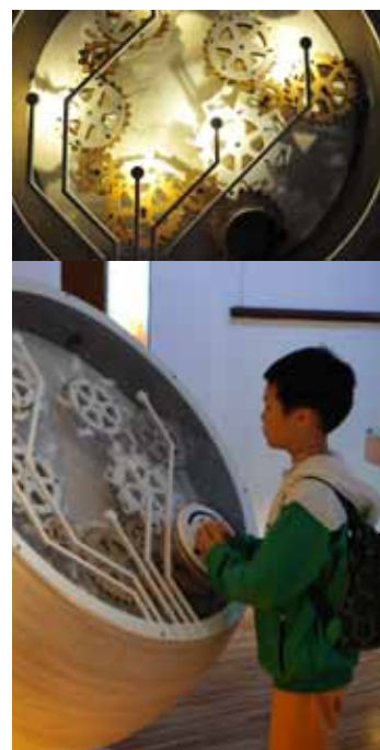
展示裝置運用「視覺暫留」原理，分解生物運動的方式，當齒輪運動轉動時，同時利用磁力感應閃光燈，產生視覺上生物運動的影像，藉以呈現「生物大逃亡」的展示意涵。
