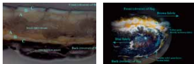
咖啡色區域織品的彩繪層橫切面切片(左)與咖啡色與藍色接縫處之彩繪層橫切面切片(右)A層為基底層，B層為亮白色的顏料層，為使彩繪影像其表面光滑，C層為老虎彩繪
