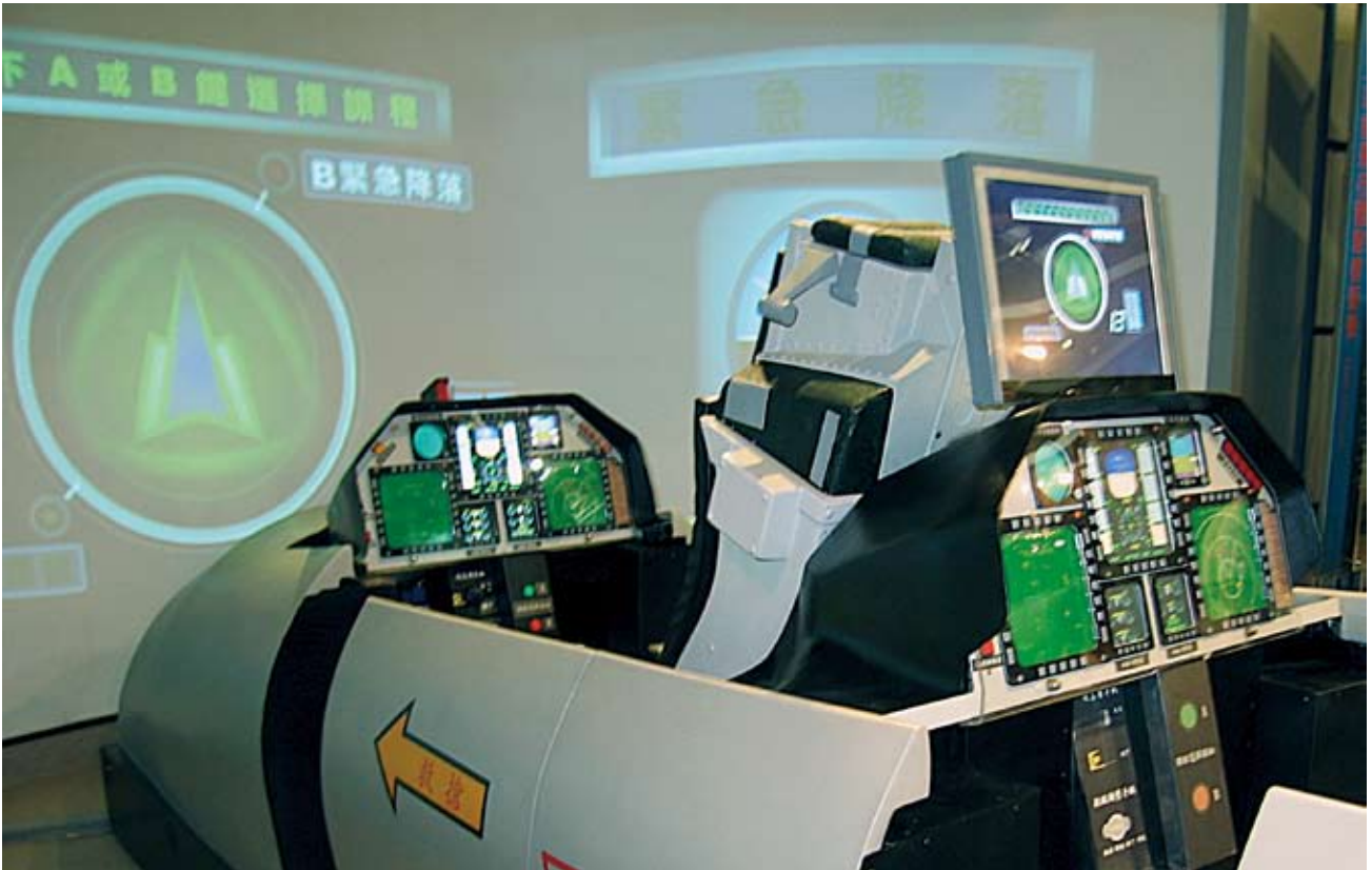
圖11 機艙內擬真的飛行儀表與抬頭顯示器影像，以及模擬操縱桿、方向舵踏板、油門手柄等，讓觀眾體驗操控飛機的真實感。(王藝瑛 攝)
