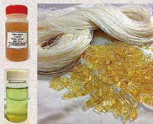
圖7 (a) 奈米雲母分散液；(b) 具放射遠紅外線及抗紫外線功能之紡織品。
