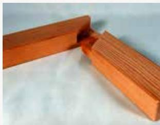
圖5「軟斜翹皮暗榫」榫卯相片—分解
