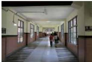
根據文獻記載，日治時期的中央走廊的地板以阿里山產的檜木鋪設，上鋪牛皮，當時醫護人員均需換上拖鞋，以免損傷皮面地板。現在的中央走廊已經全部改為磨石子地面，古意盡失。中央走廊在南端(靠近大門處)故意挑高半層樓，形成一個從南到北以緩降的坡度，方便從門診部運送病患的病床到住院部。這個斜坡每降一段又略為上升，目的是阻止病床或輪椅下滑時一直加速，處處充滿了人性化的設計。
