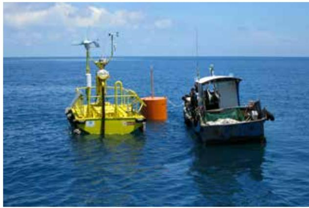
圖4 國立成功大學能源科技與策略研究中心，應用浮動式光達先進遙測技術進行離岸風力量測與風能評估。
