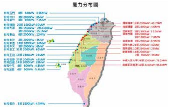
圖3 臺灣各陸域風場分布圖，臺電已完成167部總裝置容量30萬瓩的風力發電機組(藍色)，另外民營企業投資興建已完成156部總裝置容量34.8萬瓩的風力發電機組(紅色)。(圖片來源：[http://www.taipower.com.tw/content/new\\_info/new\\_info-b31.aspx?LinkID=8](http://www.taipower.com.tw/content/new_info/new_info-b31.aspx?LinkID=8))
