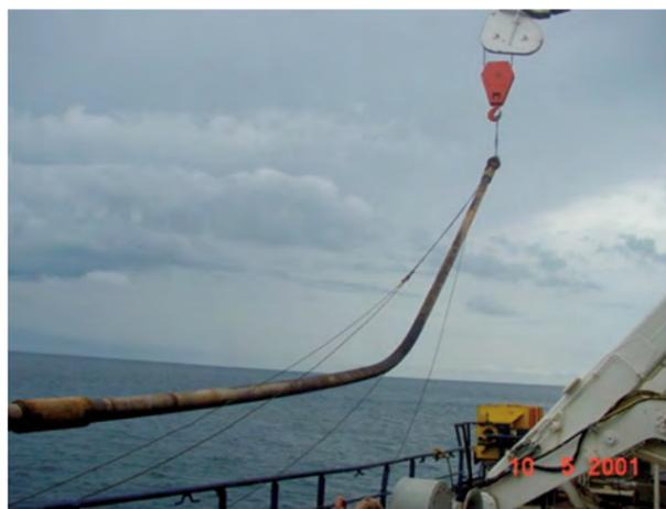
圖5 探鑽失敗的結果，整根鋼管彎曲
