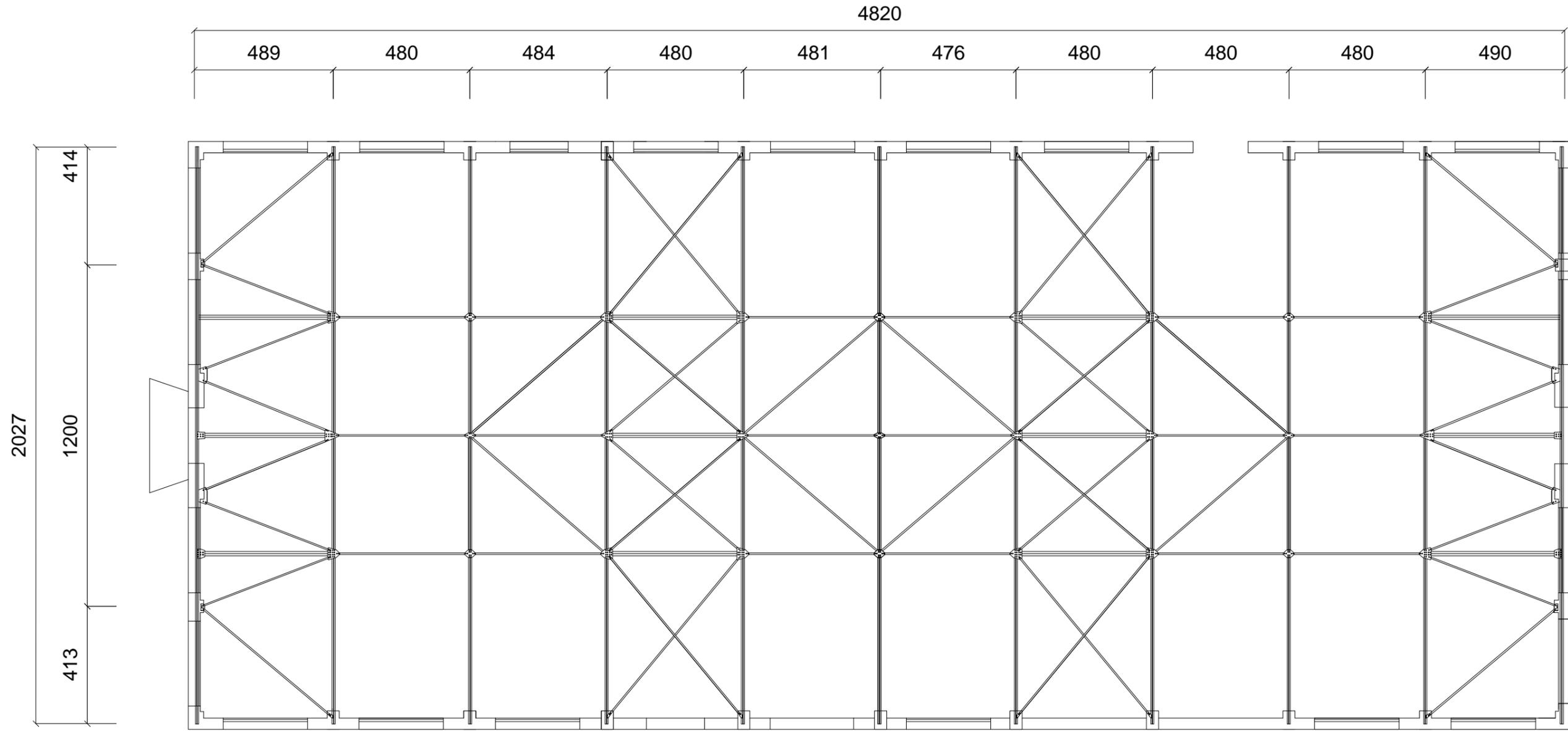
壓鋼工場屋架反射平面圖(下層)
