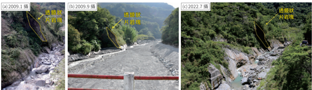
圖5 觀察地點2【霧鹿橋】。(a) 風災前，由舊霧鹿橋上向馬里蘭溪上游望去；(b) 風災後，馬里蘭溪受到莫拉克風災帶來的土石淤積，由溪畔的透鏡狀片岩塊作為比例尺來比較，風災後河道變寬至少3倍；(c) 如今，舊霧鹿橋已經拆除，以斜向拍攝，溪床中大多數的沉積物被搬運殆盡，河道變窄並逐漸回復原貌，溪水已下切至基盤岩層(箭頭示今昔對比位置)
